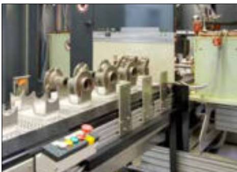
Prüfung von Radnaben (liegend)
