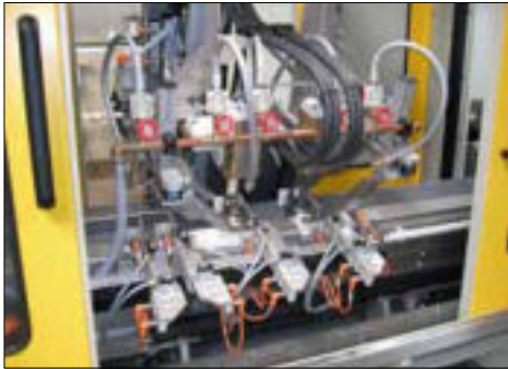
Prüfung von Radnaben (stehend)
