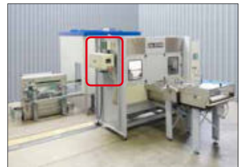
Prüfmaschine mit angebautem FLUXA-CONTROL (Automatische Prüfmittelüberwachung)
