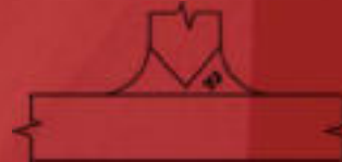
31 Porosity in Fillet (sub-surface) UT, RT
