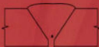
39 Porosity in Fillet (sub-surface) UT, RT
