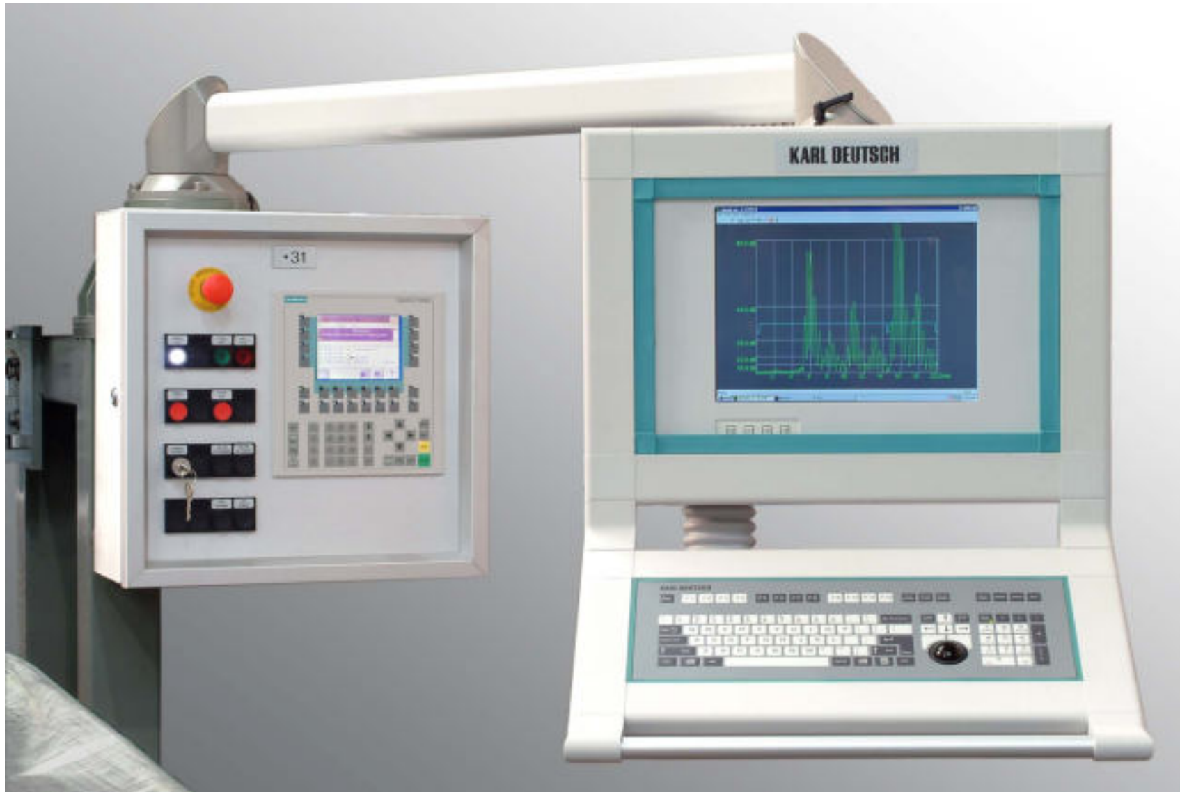
ECHOGRAF 1155 Bedien-Anzeige-Gerät (BAG)
