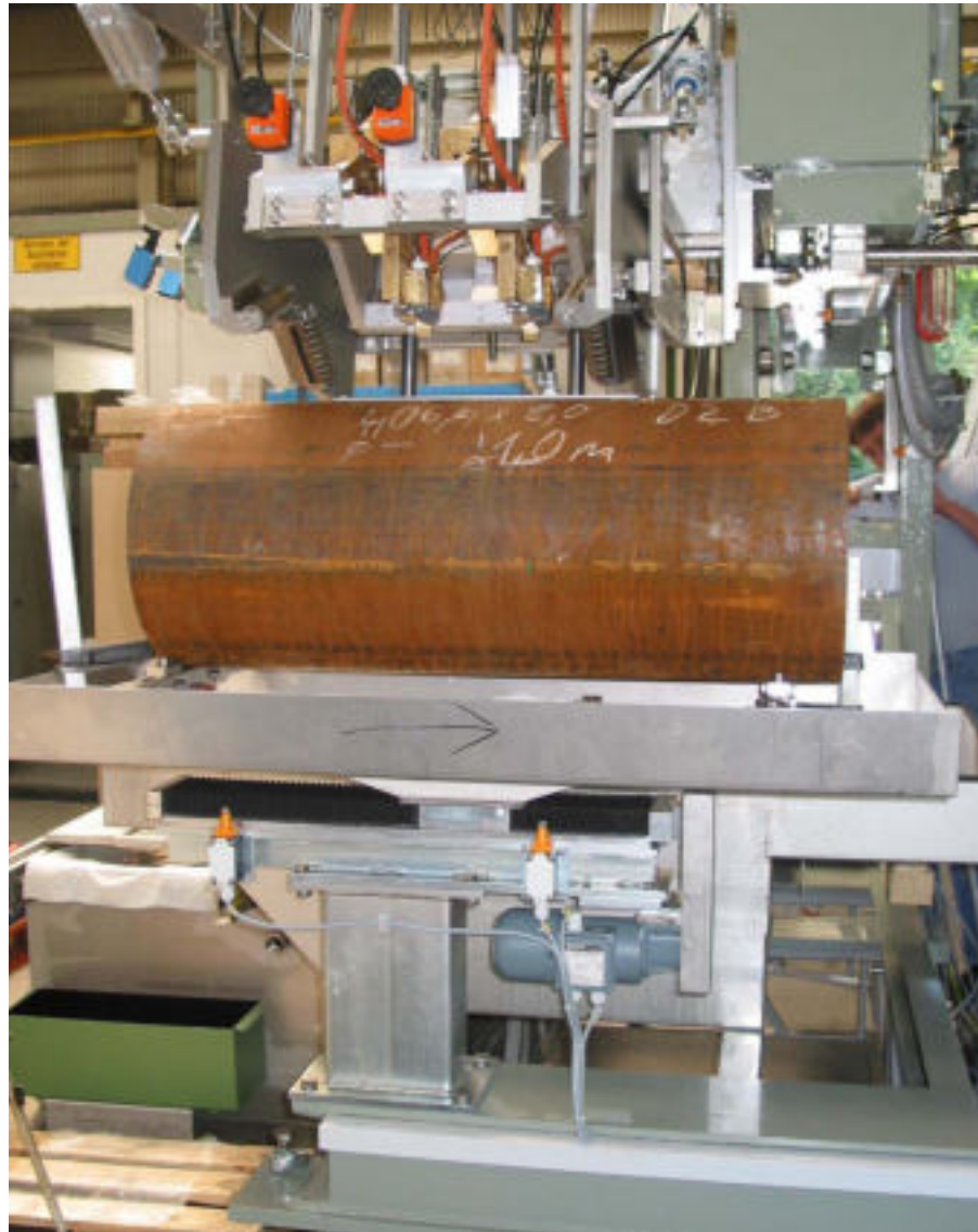
SNHF motorisierte Kalibrier-Station SNHF Motorized Calibration Stand
