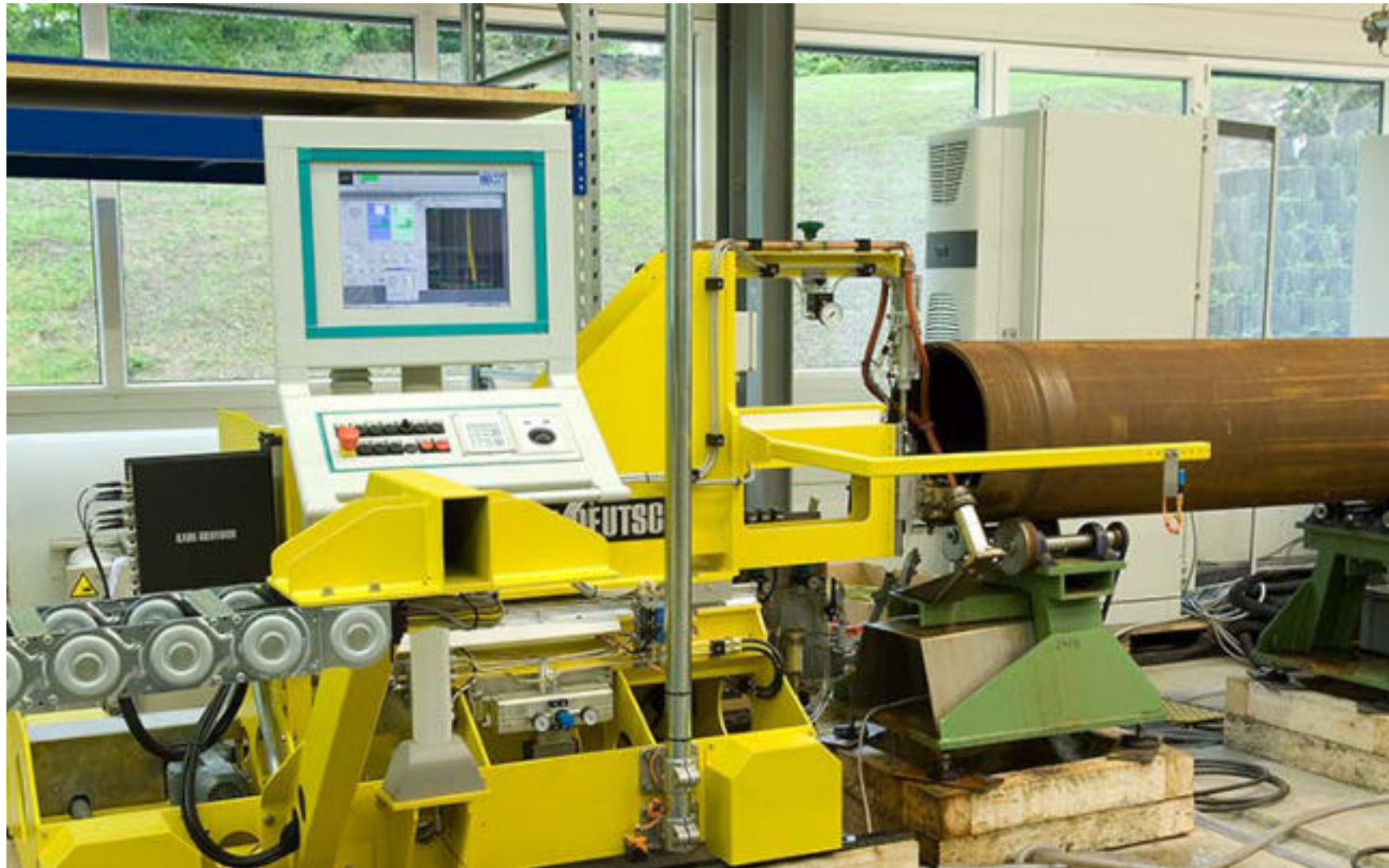
REPI-Echograph 1155: Rohrenden-Prüfung Pipe End Test @ Baosteel 2007
