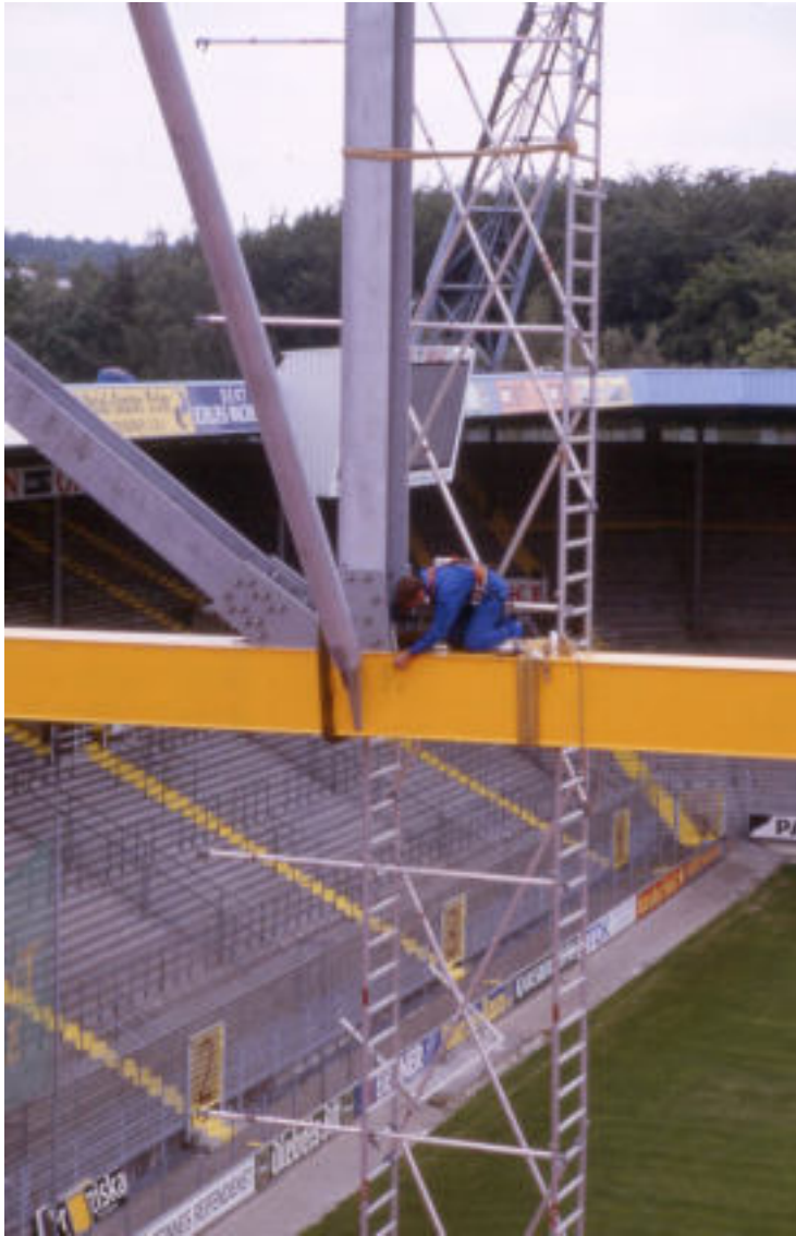
UT-Schweißnahtprüfung im Stadium (SLV München)
