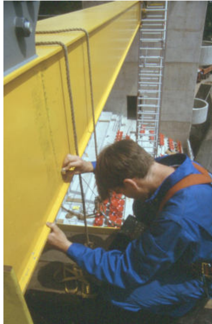
UT-Schweißnahtprüfung im Stadium (SLV München)
