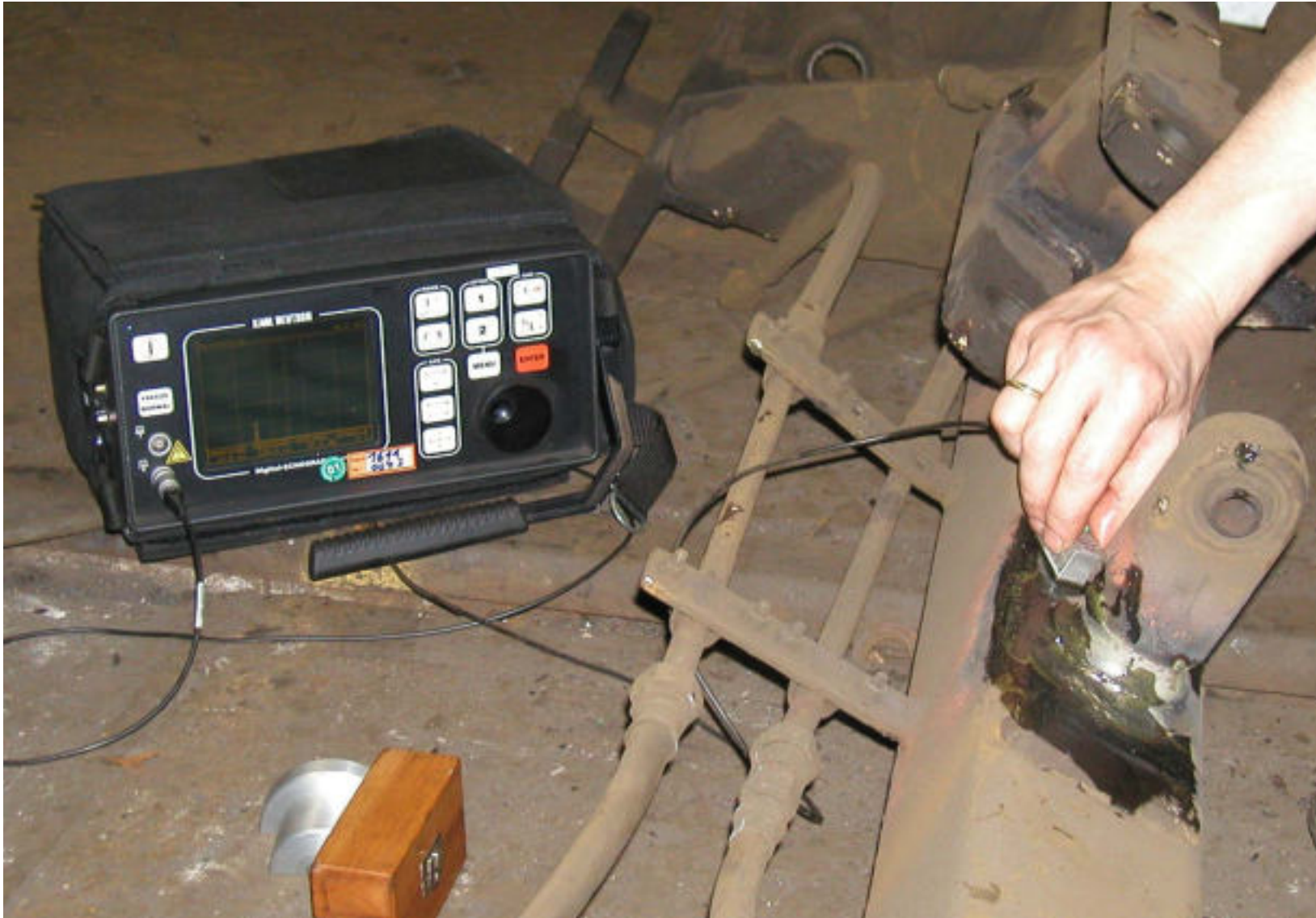
Ultraschall-Schweißnahtprüfung am Drehgestell
