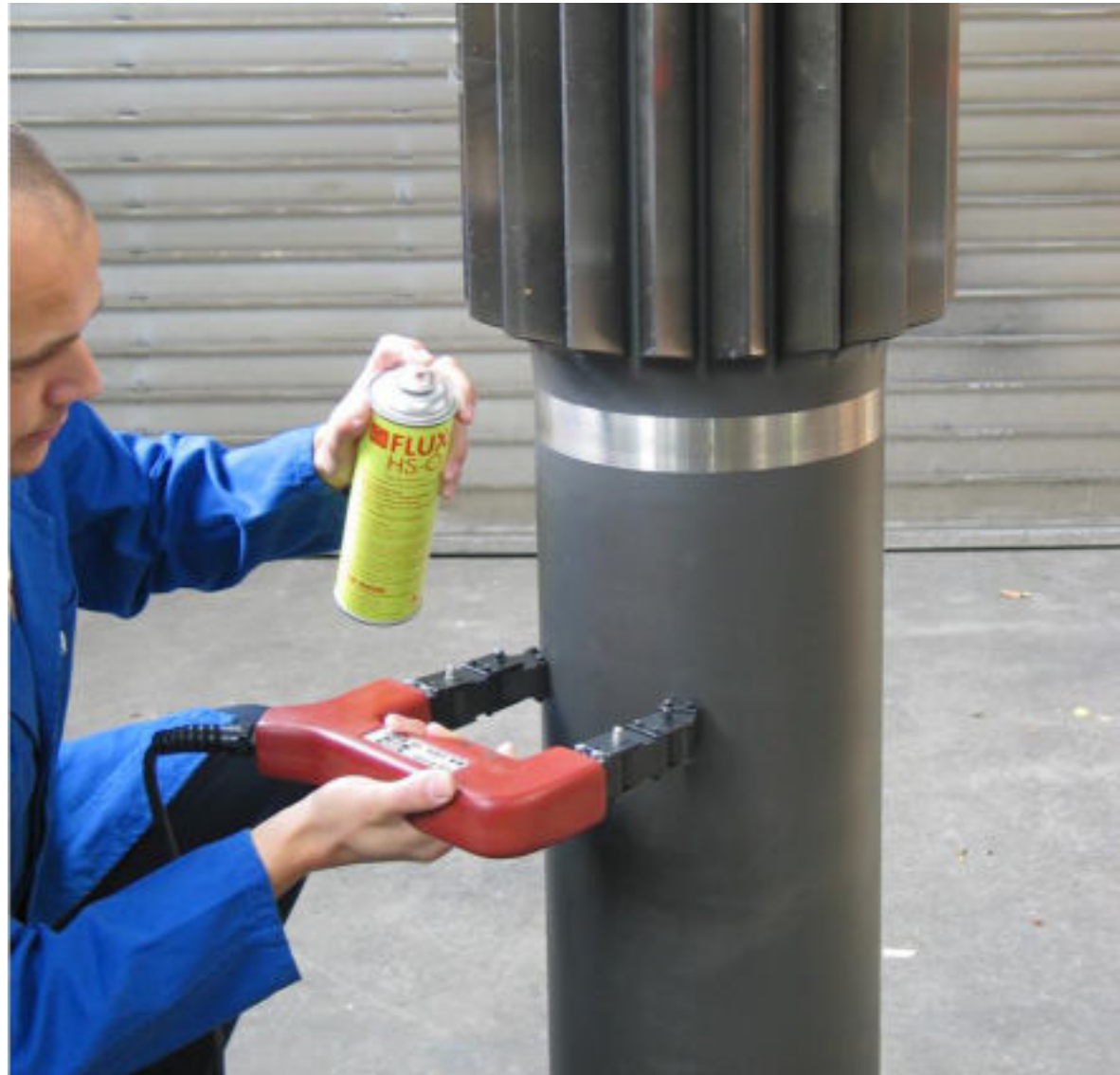
Deutropuls: MT-Prüfung an geschmiedeter Welle MPI on Forged Shaft
