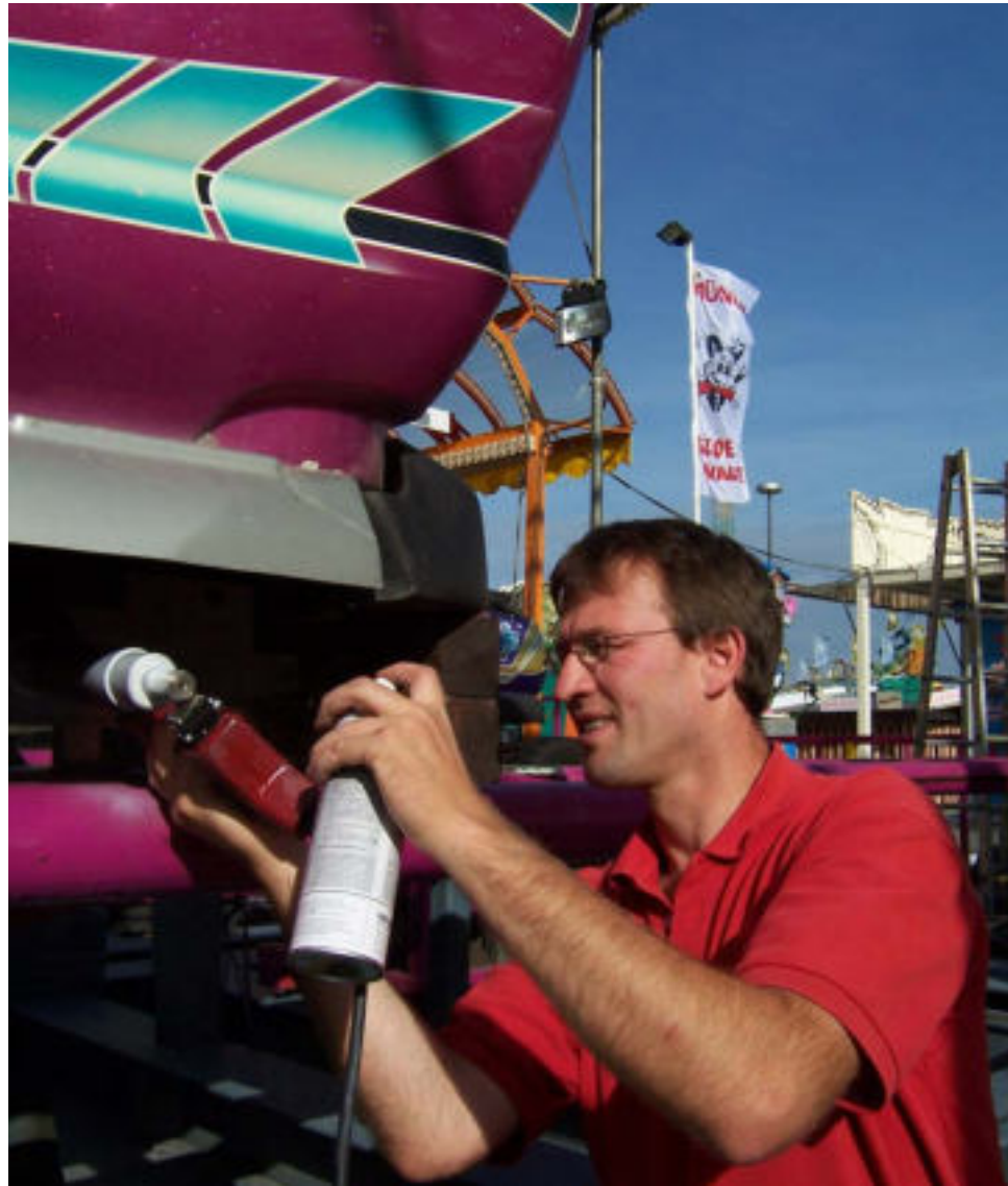
DEUTROPULS Rissprüfung an Achsen einer Achterbahn
