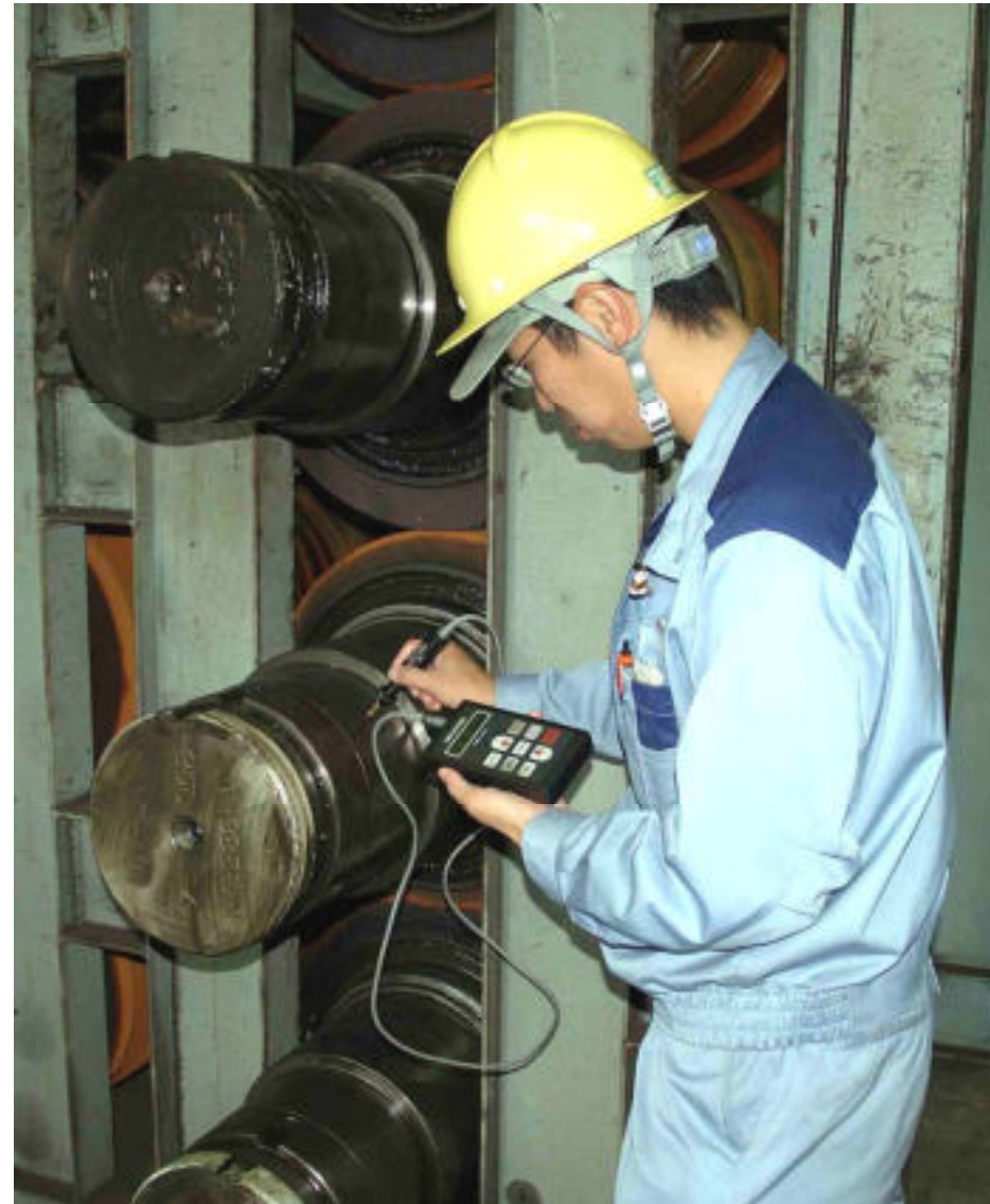
RMG Risstiefen-Messung Crack Depth Measurement
