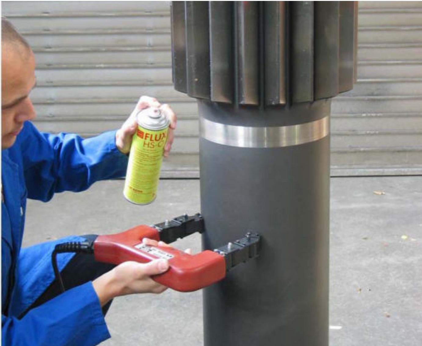
DEUTROPULS: Handjoch-Prüfung an geschmiedeter Welle MPI on Forged Shaft
