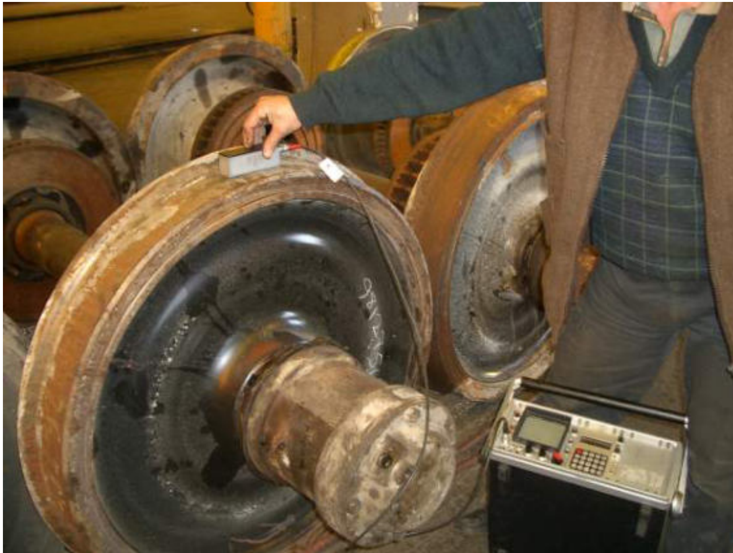
Laufflächen-Prüfung mit Spezial-Winkelprüfkopf (Oberflächenwelle)
