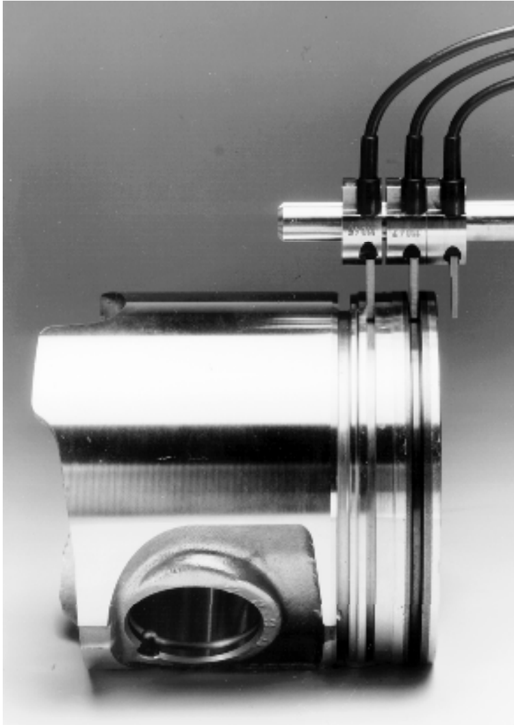
Kolbenprüfung (Ringträger) Piston Testing (Ring Groove)
