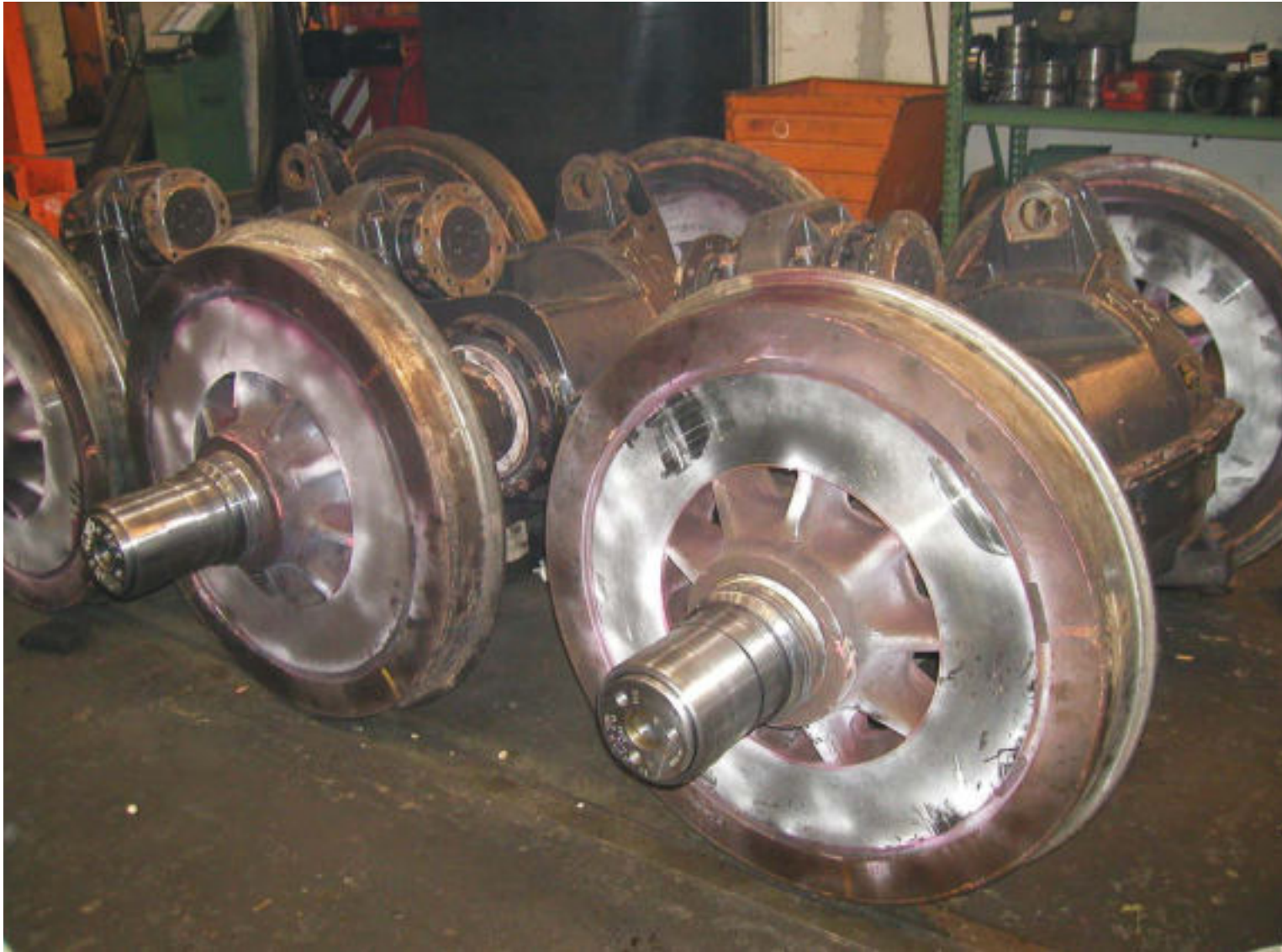
Eindring-Prüfung an Eisenbahnrädern (Reuschling Hattingen)
