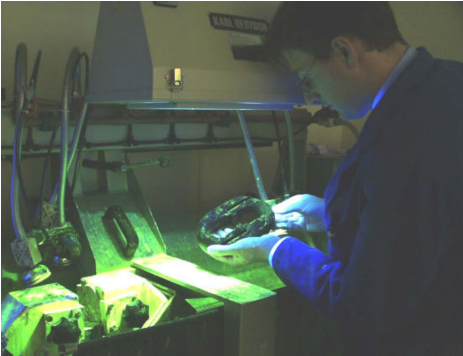
Auswertung unter UV-Licht Inspection under UV-Light
