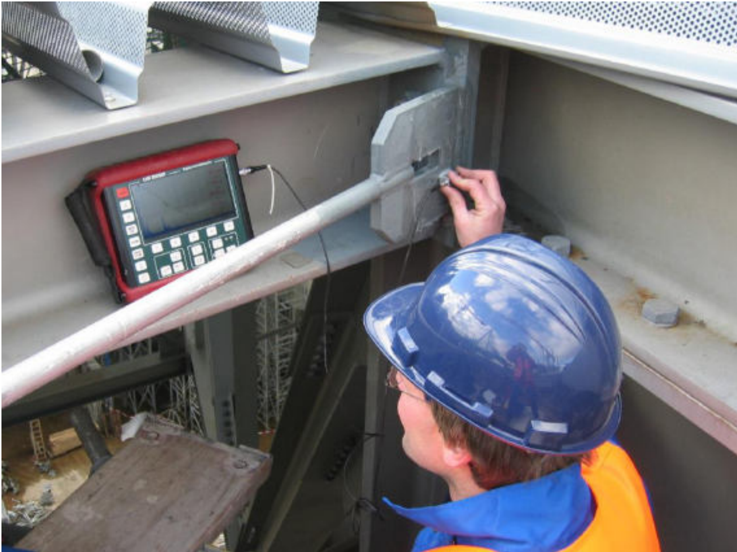
ECHOGRAPH 1090: Schweißnahtprüfung (Stahlbau)
