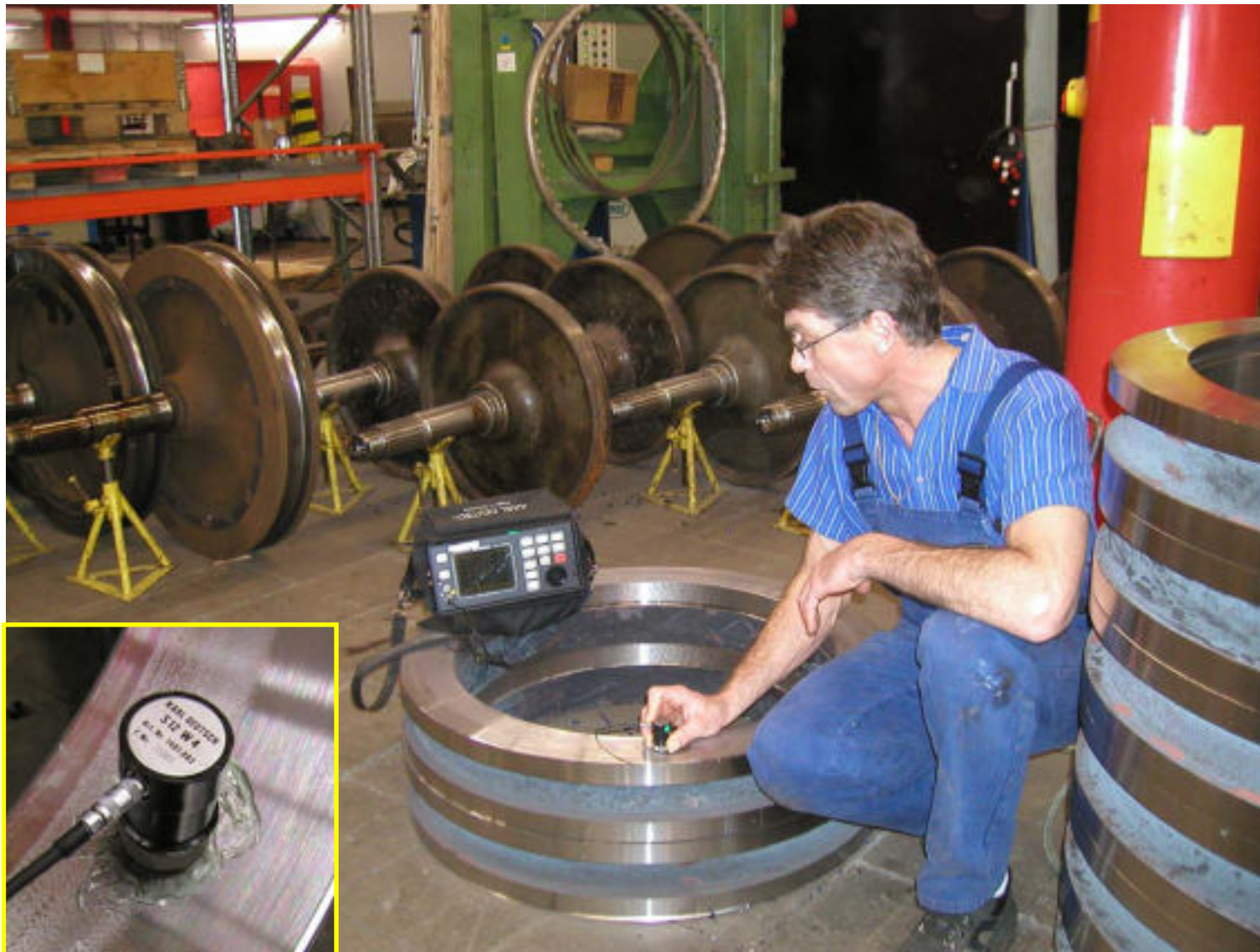
Ultraschall-Prüfung eines Radreifens (Schwebebahn)
