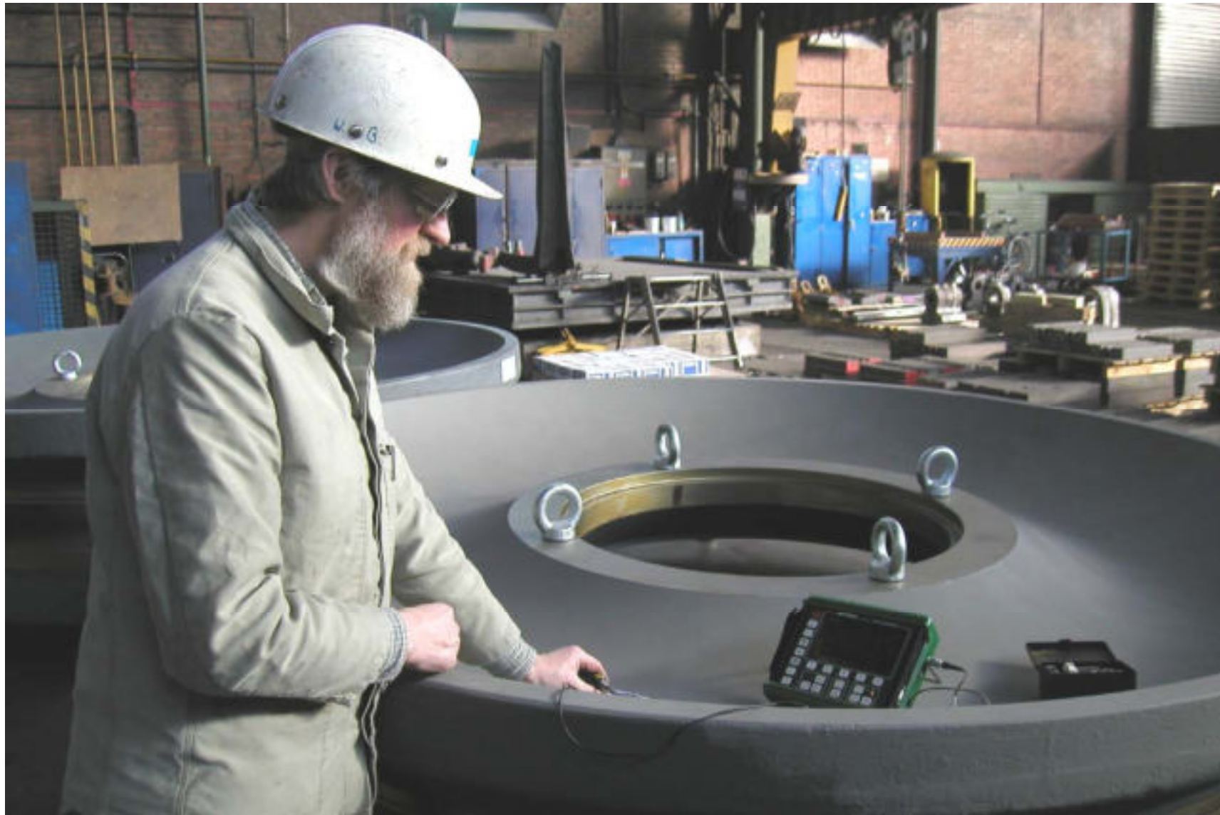
Gußprüfung mit Digital-Echograph1090 Casting Test with Digital-Echograph1090
