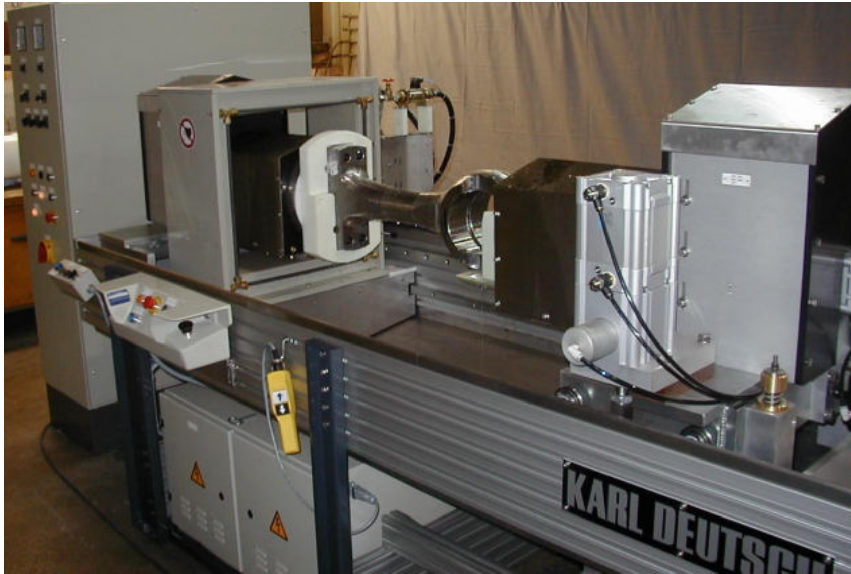
MP-Prüfung großer Pleuel (Schiffsmotoren) MPI of Large Piston Rods (ships)
