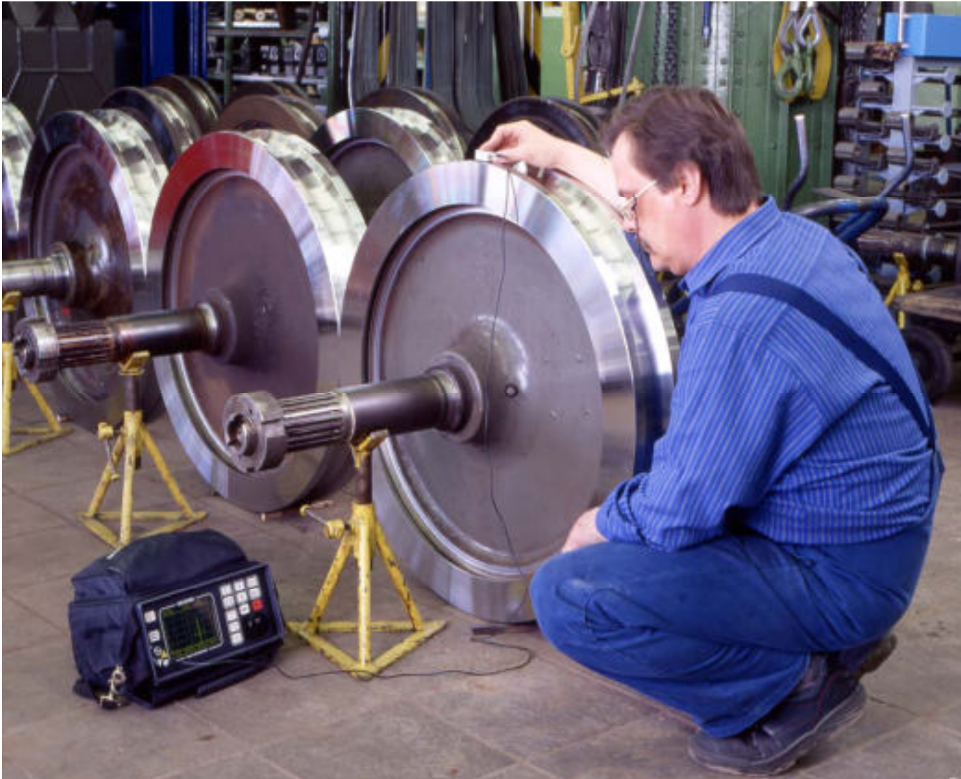
Ultraschall-Prüfung an Lauffläche (Schwebebahn)
