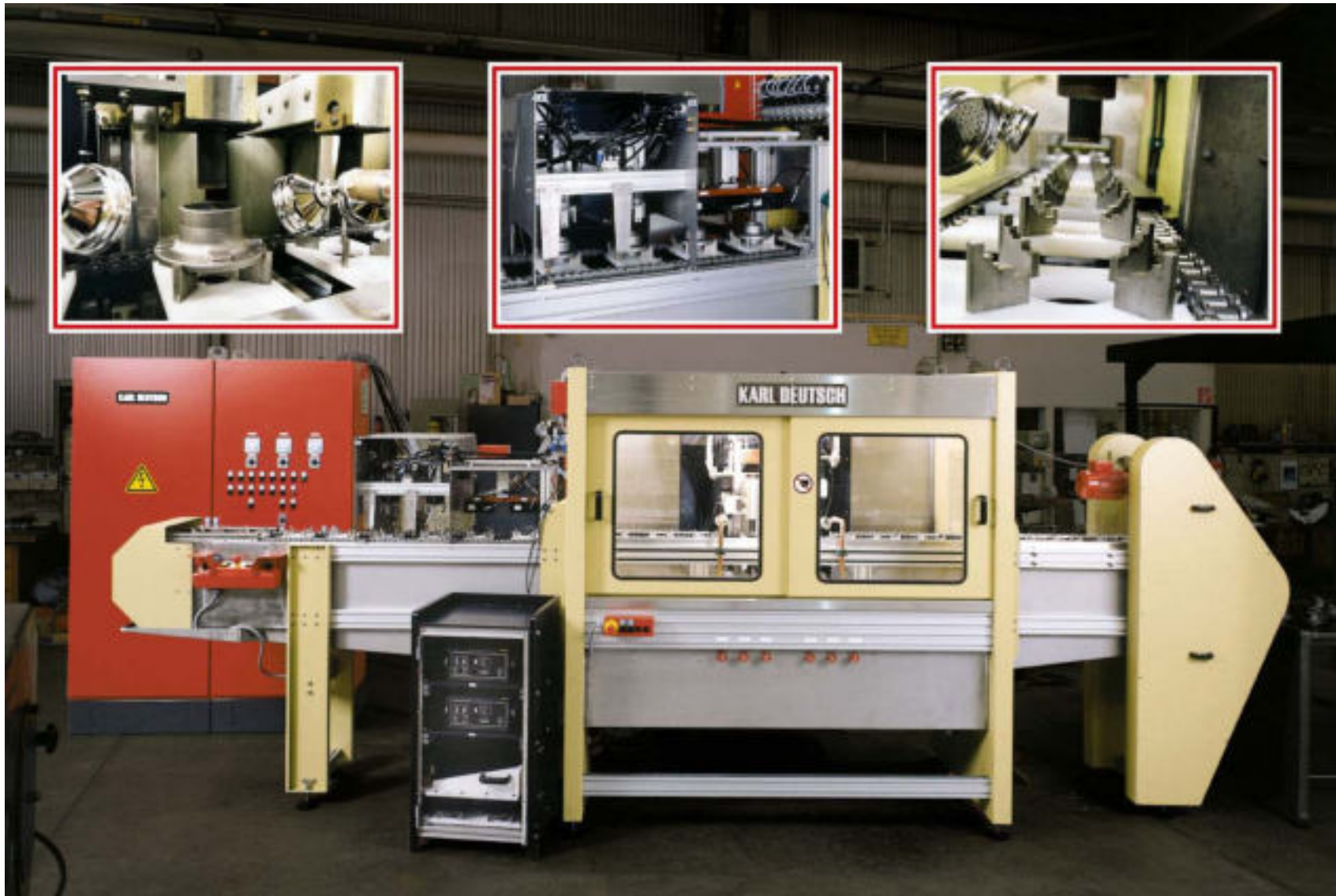
Kettenförderer, Vertikale Kontaktierung Chain Conveyor, Vertical Contacts
