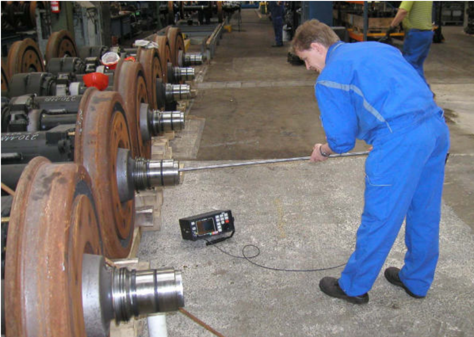
Hohl-Achsenprüfung mit Ultraschall (DB Krefeld)
