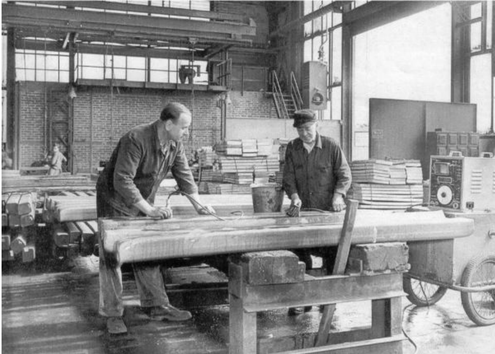
ECHOGRAPH UMG30: Knüppelprüfung @ Gussstahlwerk Witten (ca 1960)
