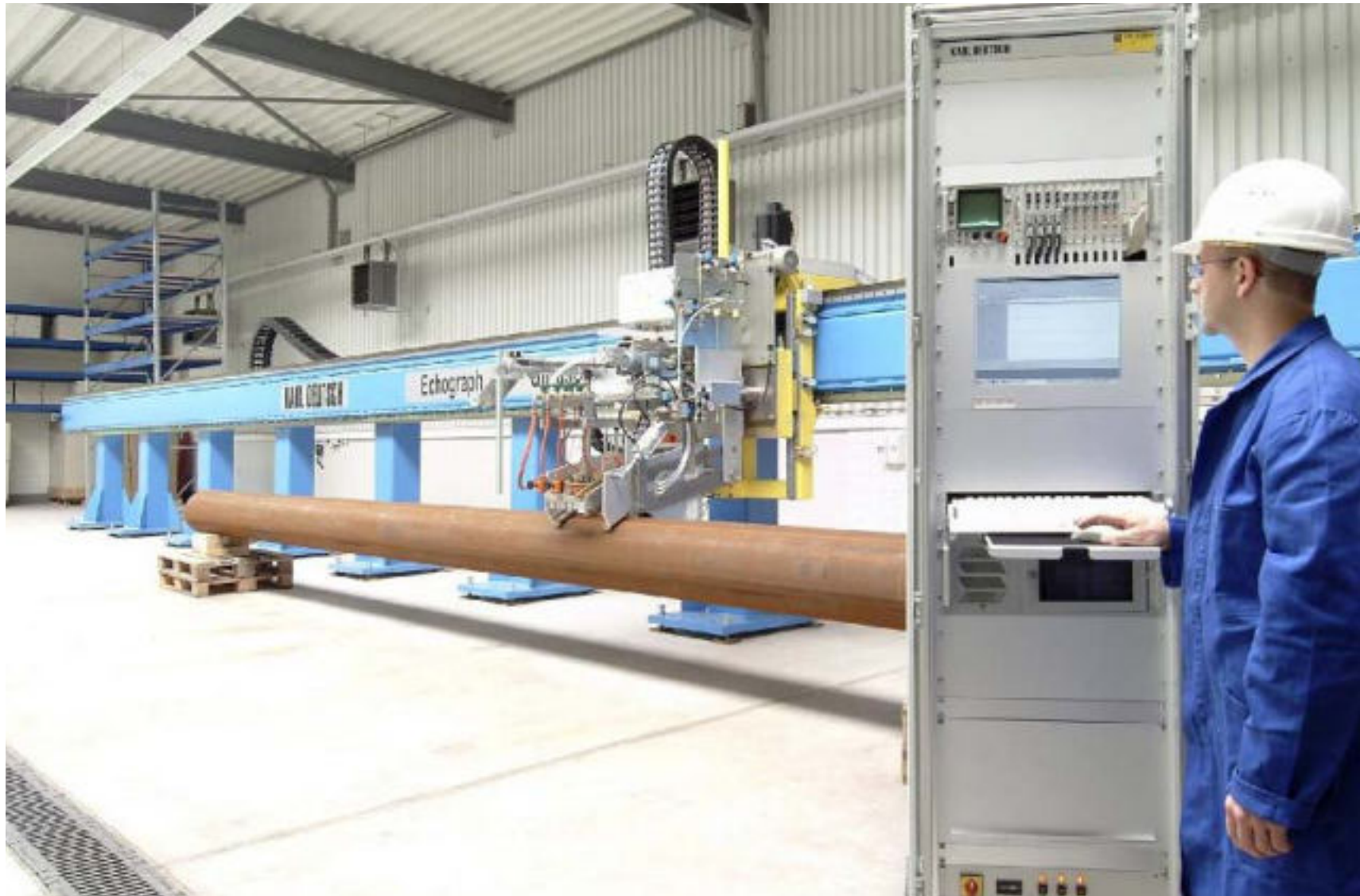
SNHF-Echograph: Prüftraverse (Einzelrohr-Prüfung) Testing Portal
