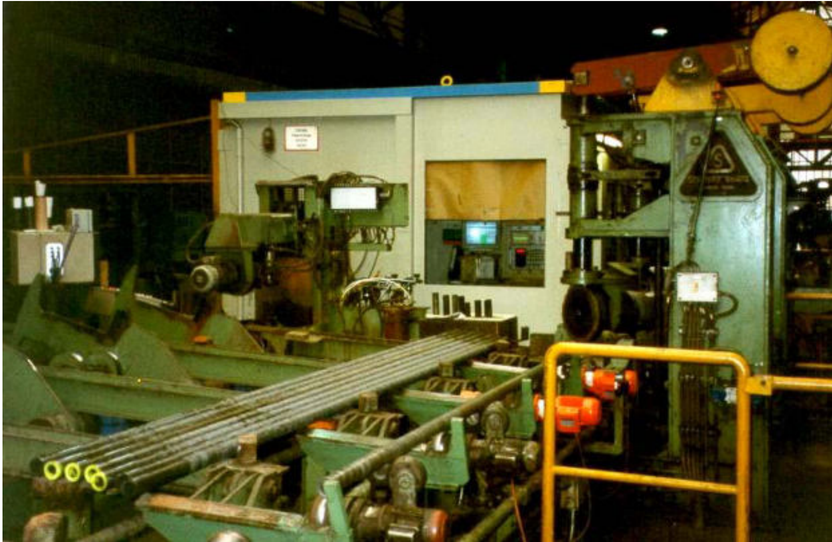
WRG Krefeld, Germany: 100%-Rohrprüfung 100%-Tube Inspection
