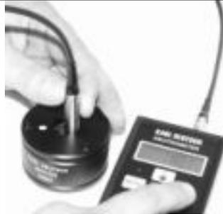
**Nullfeldkammer: Sondenvorderteil in den Ausschnitt auf dem Boden der Innenseite einsetzen.**
