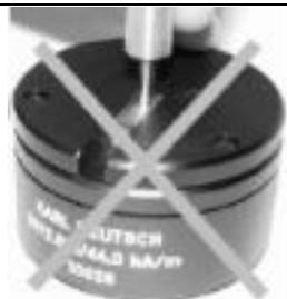
**Unterseite der Sonde zeigt nicht zum Mittelpunkt der Oberfläche.**
